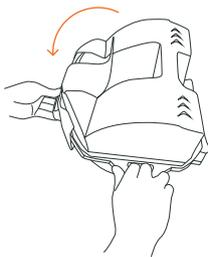
Déposez avec soin le **groupe de pressage** en le faisant reposer sur le côté gauche avec les éléments de fermeture posés sur ce même côté.
