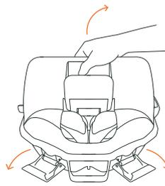
Ouvrez les éléments de fermeture afin de démonter le **couvercle du groupe de pressage** pour son nettoyage en tirant vers le haut.
