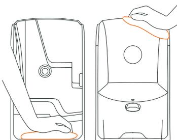
Vous pouvez nettoyer l'intérieur du châssis métallique à l'aide d'un chiffon et d'eau savonneuse. Bien rincer et sécher après lavage. Évitez d'utiliser un chiffon rugueux qui pourrait endommager la surface de la machine.
