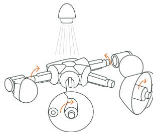
Pour un nettoyage en profondeur des pièces, tournez d'un quart de tour les **Blocages de sécurité des tambours**.
