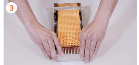
3 Retournez l'ensemble et positionnez les doigts sur le **rouleau de la bande transporteuse** en poussant vers l'extérieur pour le libérer.
