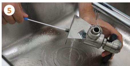
Nettoyez complètement le **robinet** en faisant passer de l'eau savonneuse par le tube. Brossez bien les deux orifices.
