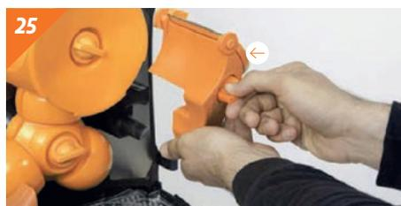
Insérer le groupe du couteau et enclencher l'axe de sécurité à l'inverse du démontage (indiqué: droite à gauche).
