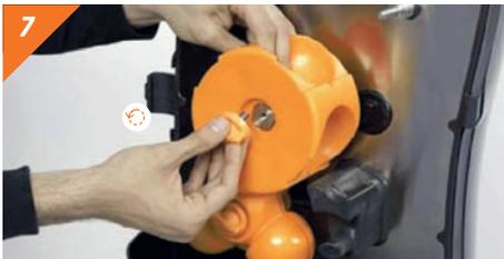
7 Relâcher et retirer les axes fixateur des tambours du système de pressage.
