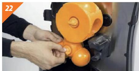
Remettre les axes fixateurs des tambours.
