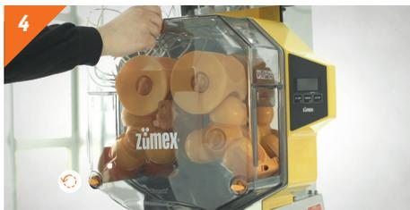
4 Retirer le capot d'extraction. Système à ergots fixes **Click&Clean**, facilite le nettoyage et la manipulation.
