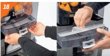
Replacer le filtre et réservoir.
