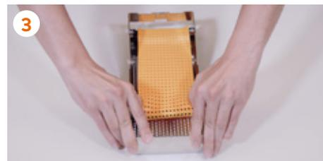
3 Si capovolge il tutto e si mettono le dita sopra il **ruolo della nastro di rimozione polpa** spingendo verso l'esterno per liberarlo.
