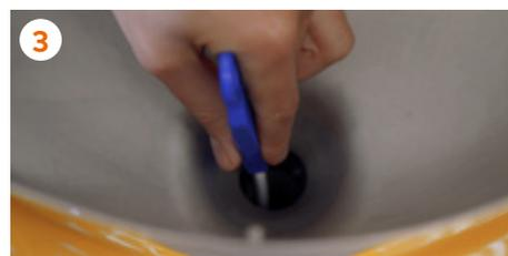
3 Introdurre la spazzola nell'orifizio **Drain& Clean** della base dell'alimentatore eliminando i residui presenti nello scarico.
