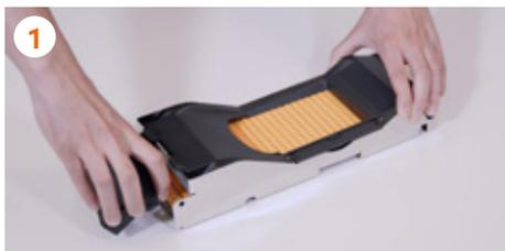
1 Su una superficie liscia si appoggia il sistema PulpOut e si smonta il **carter laterale**, tenendo fermo dalla parte superiore per estrarre i punti delle guide.
